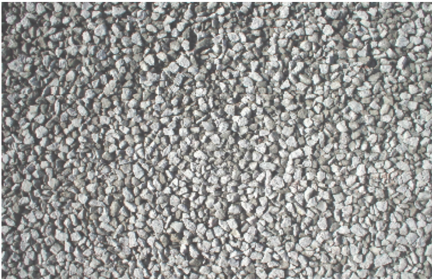
Bild 1 Nyutlagd, opackad yta av makadam, 8-22 (IMT).
